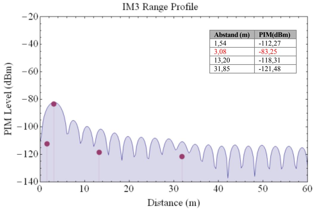
Schritt 4 - 2. RTF-Analyse (nach Behebung der PIM-Quelle in 3m Entfernung)
