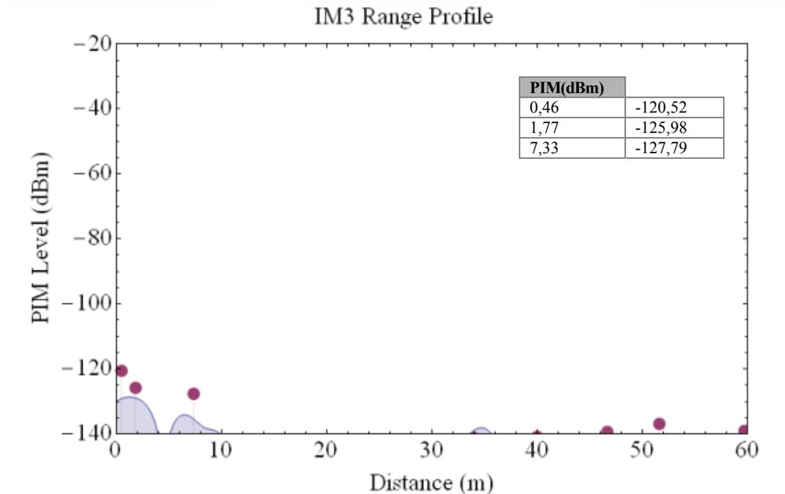
Schritt 7 - Ergebnisse des dynamischen PIM-Tests (zeigen ein PIM-Problem, das weder beim statischen PIM-Test noch bei der RTF-Analyse entdeckt wurde)
